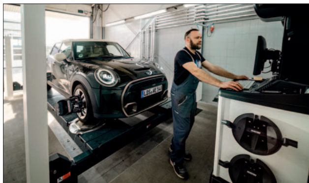
■ Die neue Achsvermessungsanlage war nötig geworden, da die Fahrzeugfortbewegung immer mehr von Sensoren gesteuert wird.
